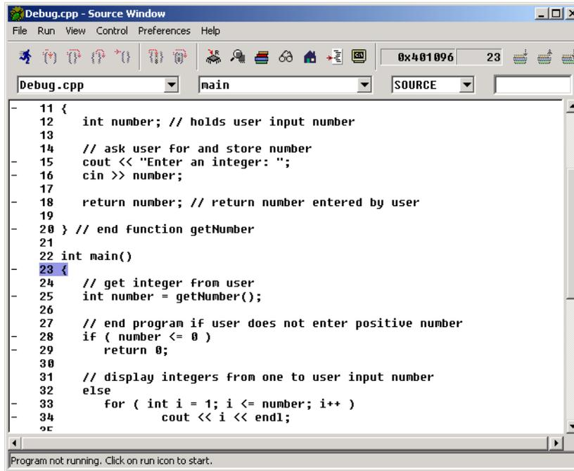
Fig. 1.23 Using the GDB debugger on `Debug.cpp`.
